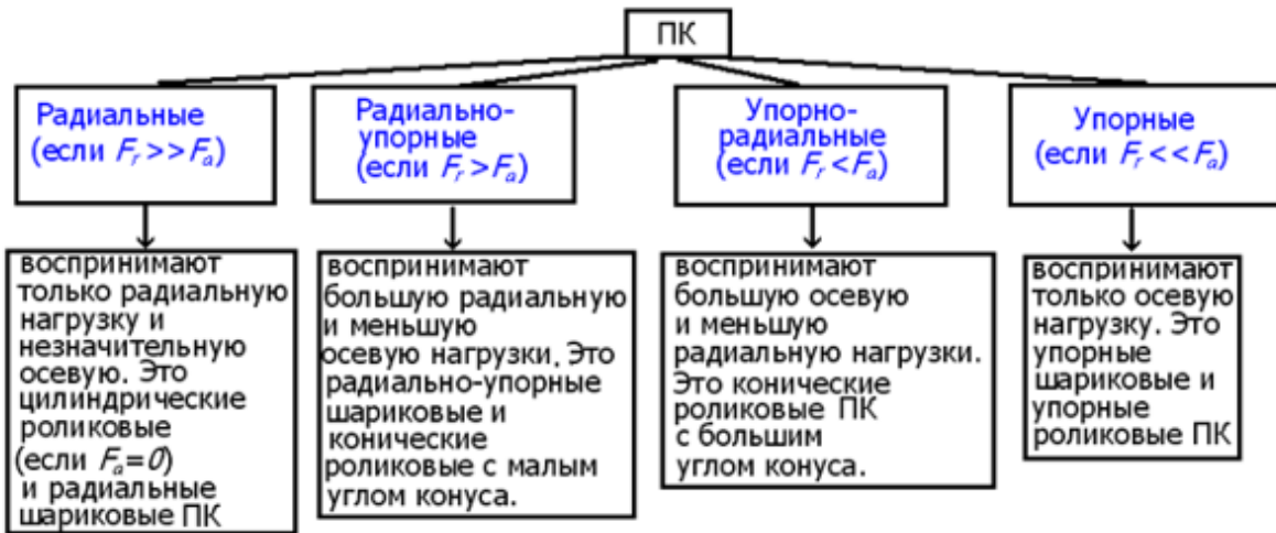
Рис. 2. Группы подшипников по воспринимаемой нагрузке
