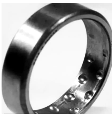
Рис. 6. Повреждения при бринеллировании
