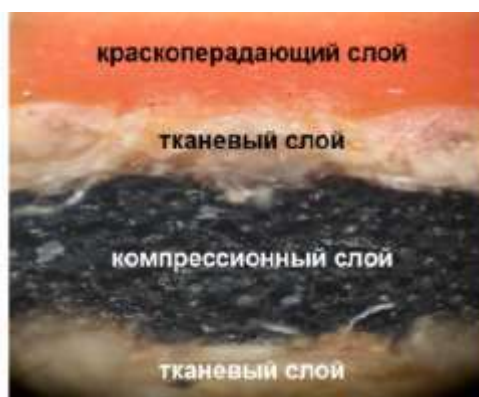
Рис. 1. Торцевой срез ОРТП Atlas Web.
