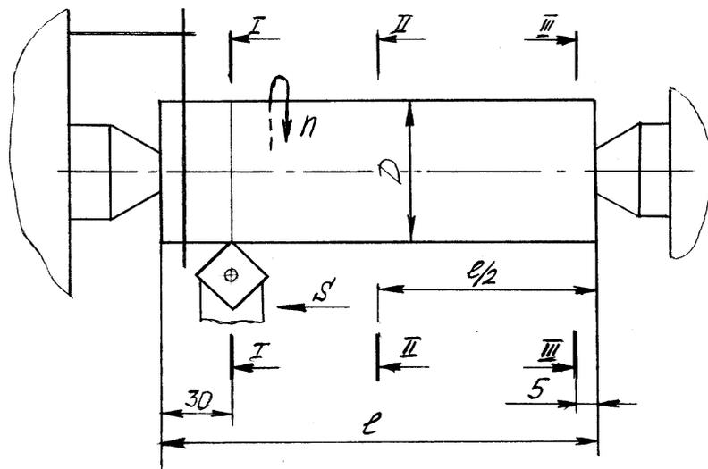
Рис. 2. Схема обработки вала на токарно-винторезном станке
