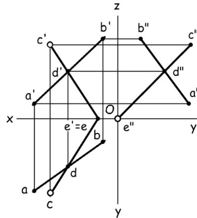
3. Построить проекции треугольника ABC, если сторона BC лежит на прямой MN, параллельной плоскости H, а сторона AC параллельна плоскости V. Основание D высоты AD делит сторону BC в отношении  $|BD| : |DC| = 1 : 2$ .
