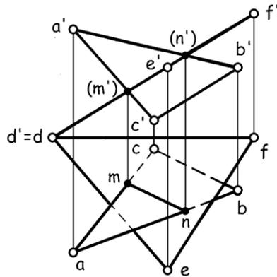
2. Построить проекции прямой, проходящей через точку C и пересекающей прямую AB и ось проекций OX.
