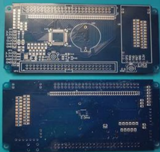
Изготовленные печатные платы аналитического модуля
