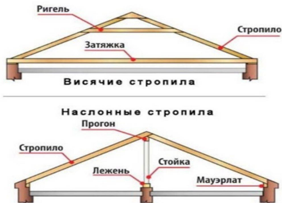
Рис. 4.4 – Виды конструкции стропильной системы
