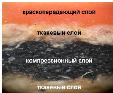
Рис. 1. Торцевой срез ОРТП Atlas Web.
