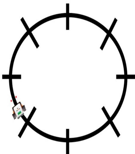
20. Придумайте алгоритм движения и нарисуйте блок-схему для решения следующей задачи. Четыре датчика освещённости позволяют роботу лучше определять крутые повороты. Внутренние датчики служат для тонкой регулировки, для них используется пропорциональное регулирование. Два внешних датчика вынесены немного вперед и разведены в стороны. Они используются тогда, когда встречается крутой поворот. Коэффициент усиления для управления по показаниям
