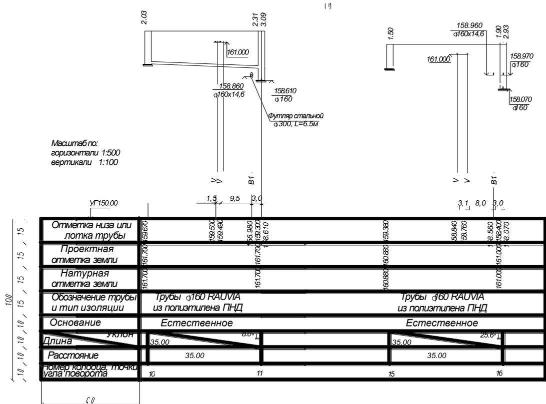
Рис.5.5. Пример построения продольного профиля дворовой канализационной сети
