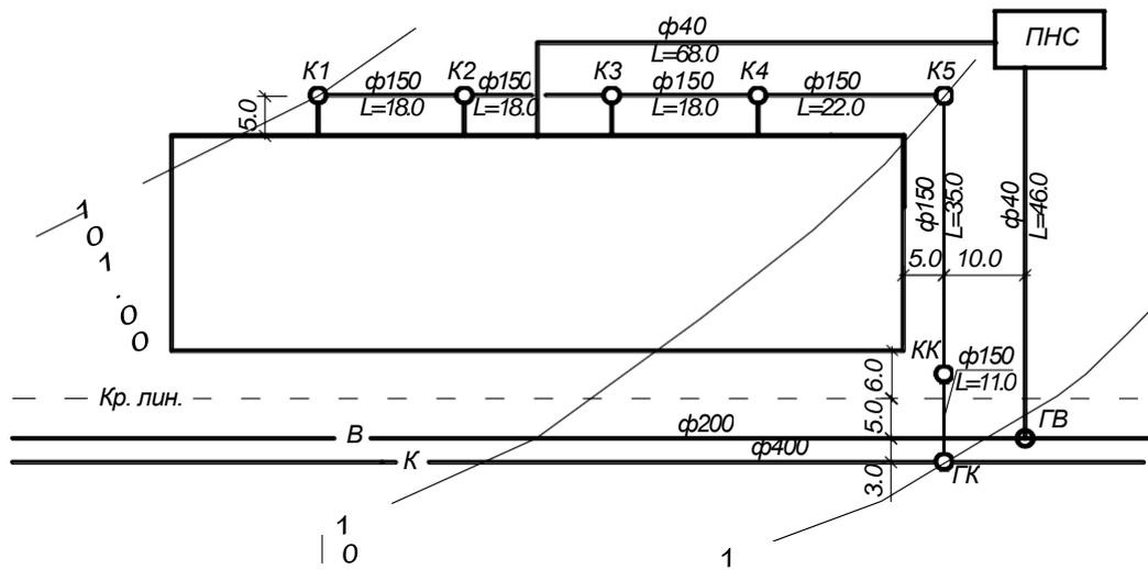
Рис.5.3. Генплан участка застройки жилого пятиэтажного дома с сетями водопровода и канализации
