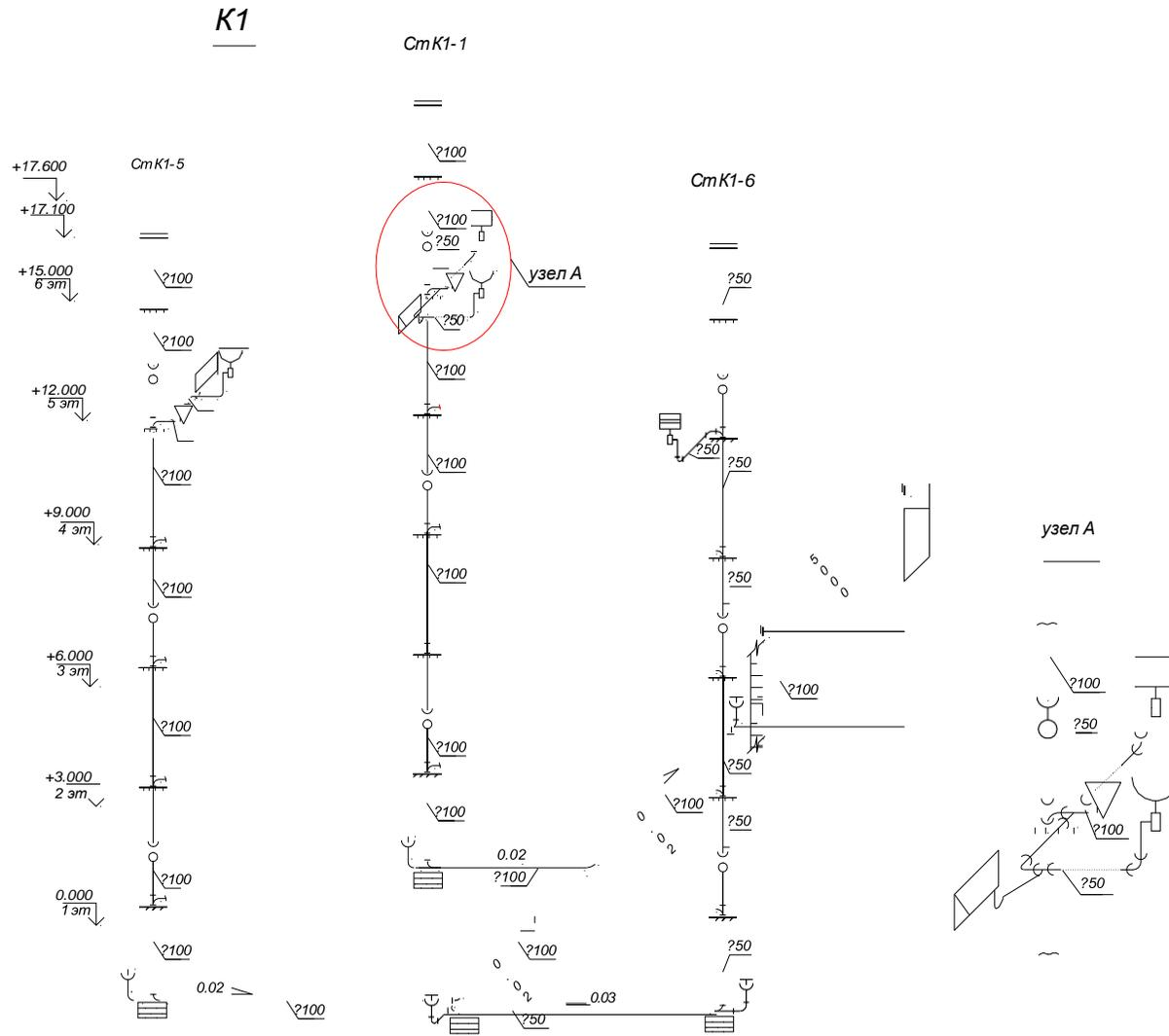
Рис.5.2. Аксонометрическая схема трубопроводов канализационных стояков и выпуска
