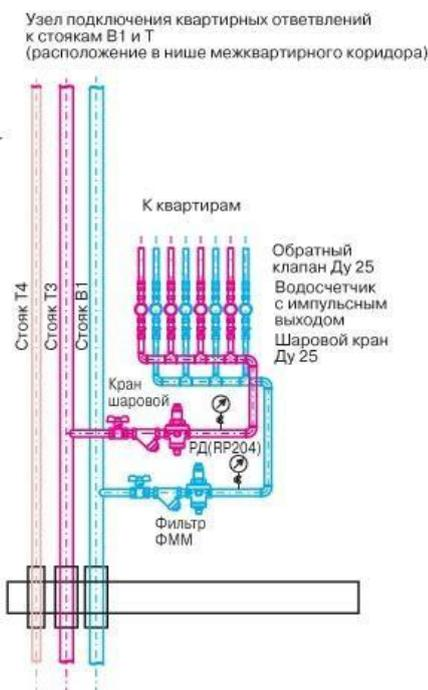
Рис. 1. Схема поэтажного коллекторного присоединения квартирных трубопроводов В1, Т3, Т4 к стоякам, расположенным в нишах межквартирных коридоров
