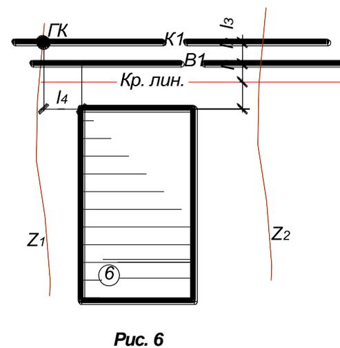
Схема привязки наружных инженерных сетей к жилому дому
