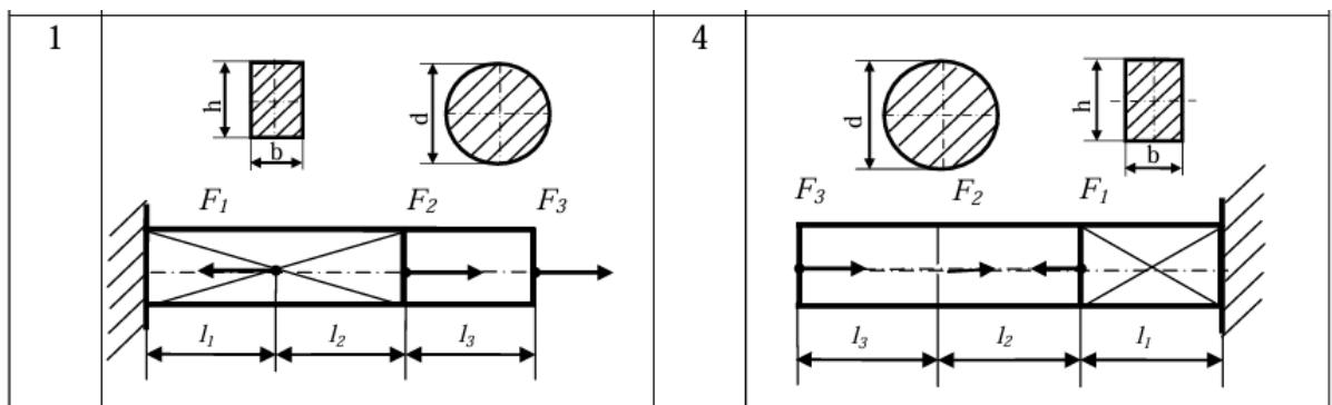
**Задание 2.** Расчет на прочность и жесткость ступенчатого стержня при кручении. Стальной ступенчатый стержень (модуль сдвига  $G=8 \cdot 10^4$  МПа; допускаемое касательное напряжение  $\tau_{adm}=56$  МПа) нагружен сосредоточенными моментами  $M_1, M_2, M_3$ . Стержень состоит из трех участков, два из которых имеют одинаковый тип и размер поперечного сечения. Принять допускаемую абсолютную угловую деформацию  $\Delta\varphi_{adm}=1$  град.
