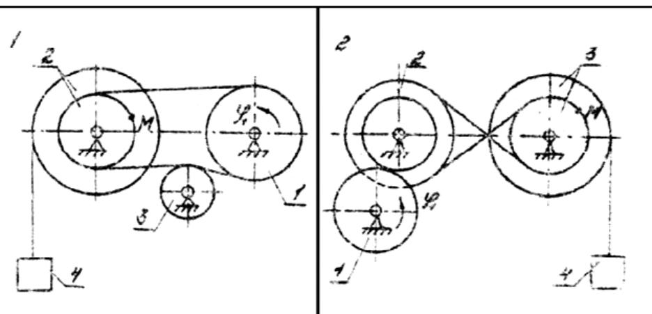
**Типовое задание для расчетно-графической работы №3 по теме "Кинематический анализ плоского механизма"**
