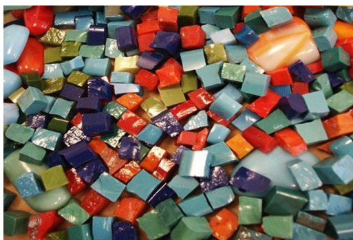
Рис. 30. Смальта: а – внешний вид; б – пример отделки фасада смальтой
