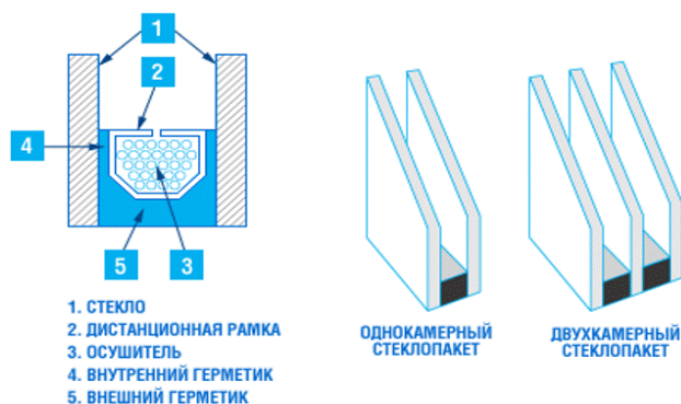
Рис. 25. Конструкция стеклопакета
