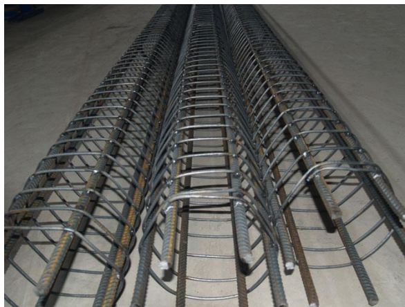
Рис. 44. Виды арматуры и арматурных изделий: а – стержневая арматура; б – проволочная арматура; в – канатная арматура; г, д – арматурные каркасы; е – арматурные сетки
