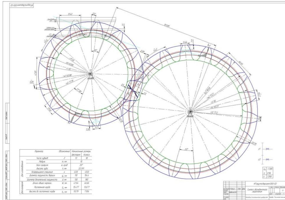
По заданным модулю  $m$  (мм) и числам зубьев колес рассчитать параметры зубчатой передачи и построить картину зацепления.
