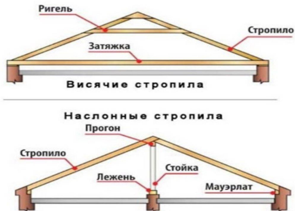
Рис. 4.4 – Виды конструкции стропильной системы
