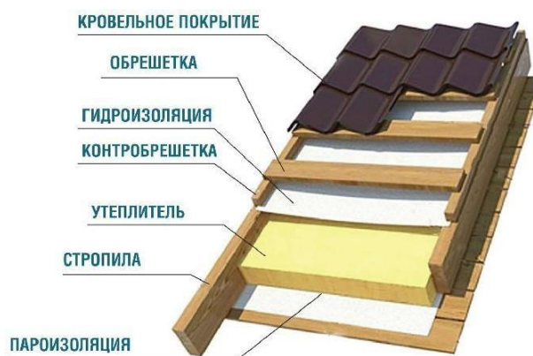
Рис. 4.7 - Вид конструкции кровельного покрытия
