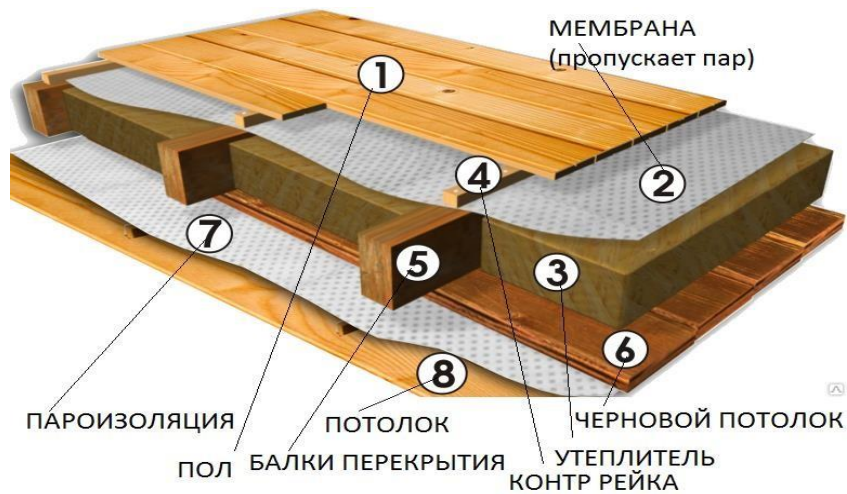
Рис. 3.1. Перекрытие цокольного перекрытия
