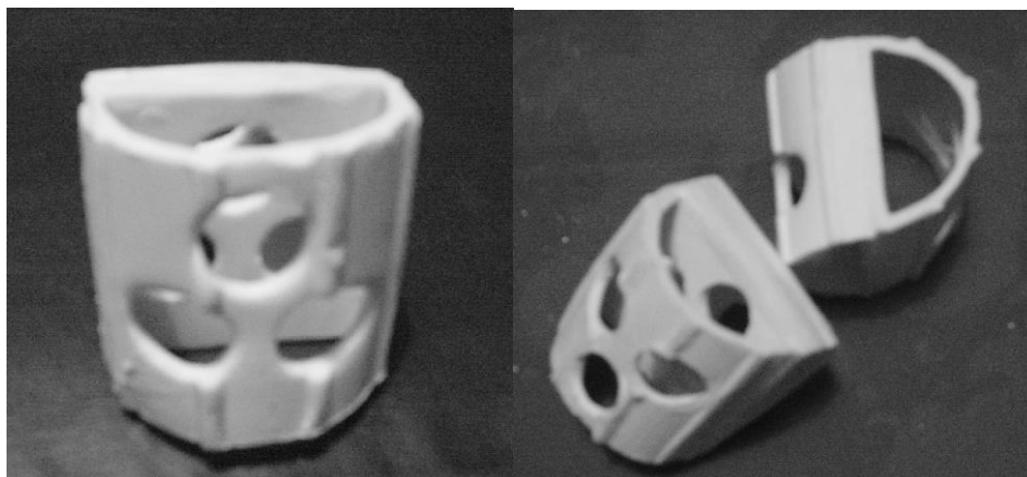
Рис. 4.9.1. Общий вид новой керамической насадки типа N3C
