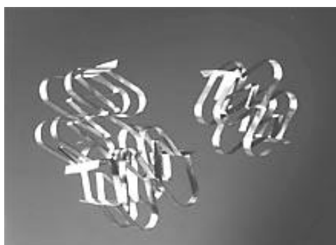
Рис. 4.4.10. Нерегулярные насадки с большой поверхностью контакта
