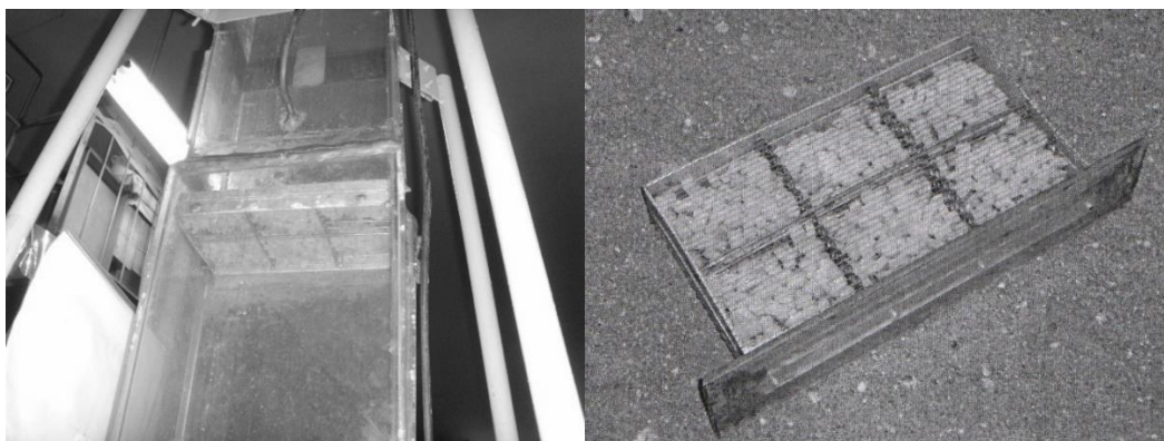
а) верхняя часть шахты с установленной кассетой
