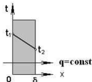
**Вопрос 27.** Найти коэффициент теплопередачи через стенку биореактора, если ее толщина  $\delta_{ст} = 9 \text{ мм}$ ,  $\lambda_{ст} = 90 \text{ Вт}/(\text{м}\cdot\text{К})$  и она покрыта слоем теплоизоляции  $\delta_{из} = 30 \text{ мм}$ ,  $\lambda_{из} = 0,3 \text{ Вт}/(\text{м}\cdot\text{К})$ . Коэффициенты теплоотдачи:  $\alpha_1 = 100 \text{ Вт}/(\text{м}^2\cdot\text{К})$ ,  $\alpha_2 = 10 \text{ Вт}/(\text{м}^2\cdot\text{К})$ , Расчет провести по формулам плоской стенки.
