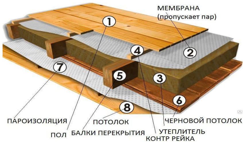
Рис. 3.1. Перекрытие цокольного перекрытия
