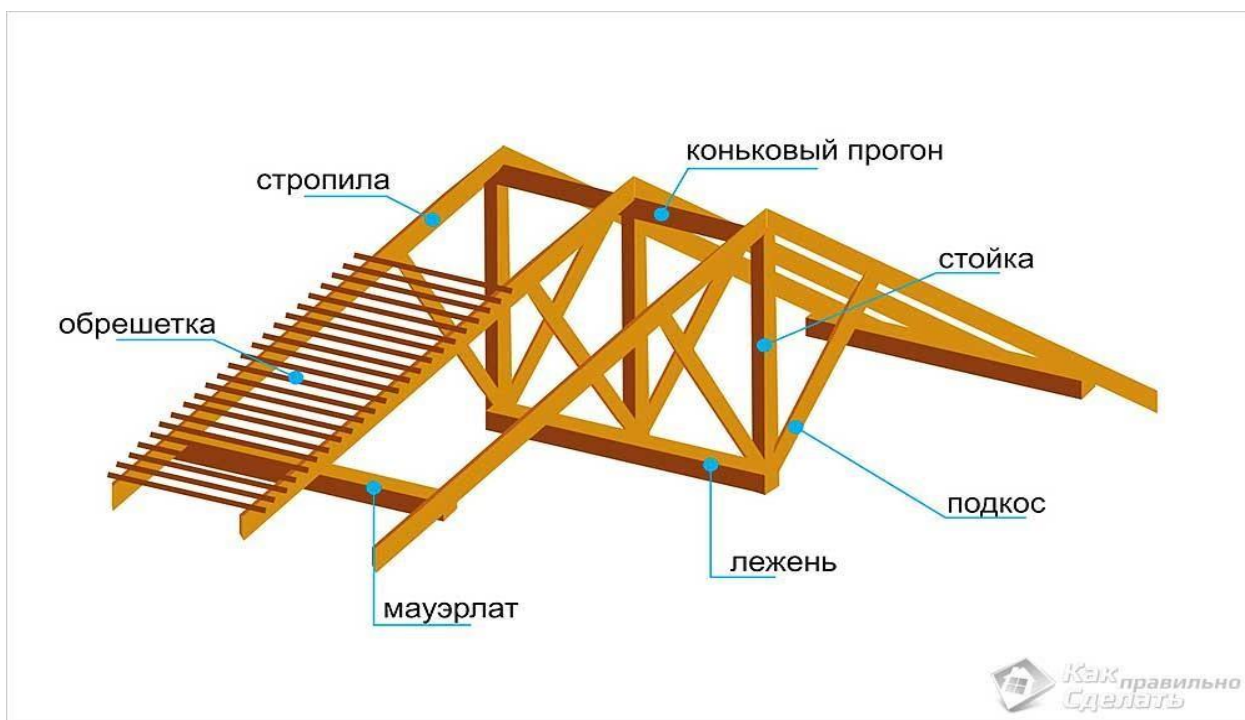
Рисунок 4.4 - Элементы стропильной системы
