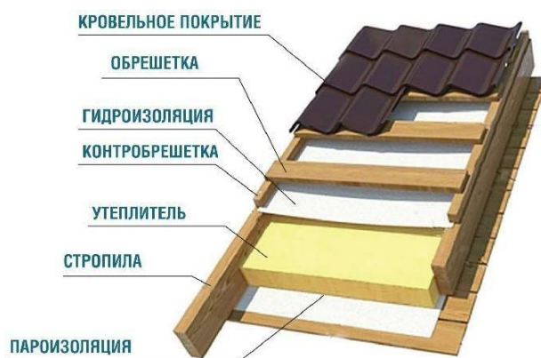
Рис. 4.7 - Вид конструкции кровельного покрытия
