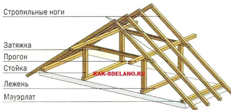
Рис. 4.5 – Схема конструкции стропильной системы
