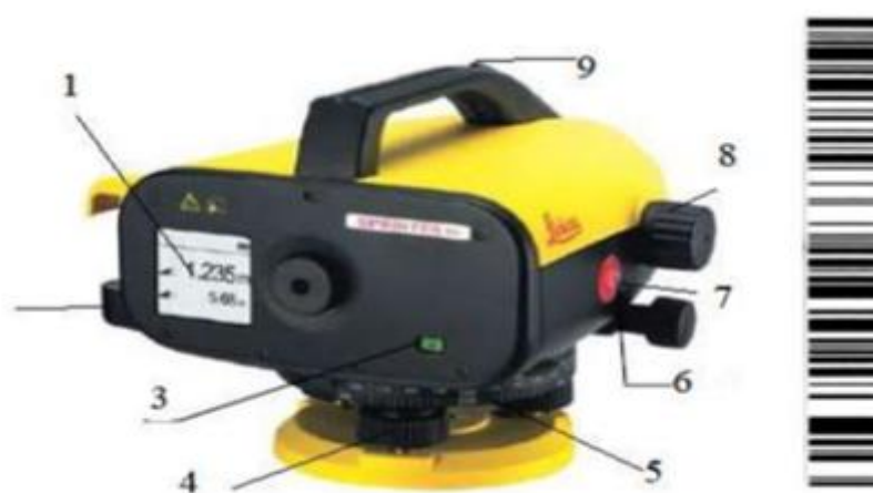
Рис.2.2. Электронный нивелир Leica Sprinter 50 и штрих-кодовая рейка (справа)
