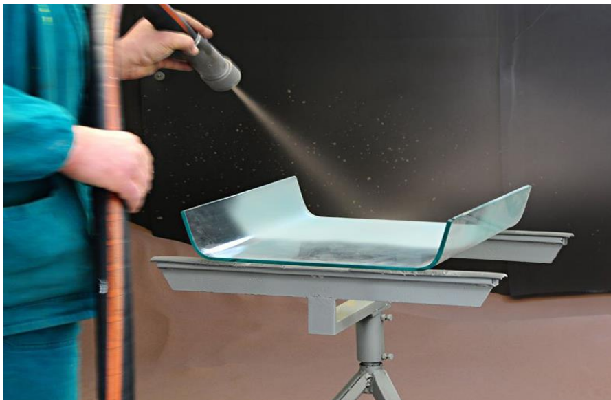
Рис. 1.4. Процесс пескоструйного матирования стекла
