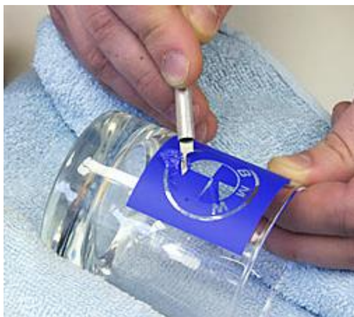
Рис. 1.2. Создание трафарета на поверхности стеклянного изделия
