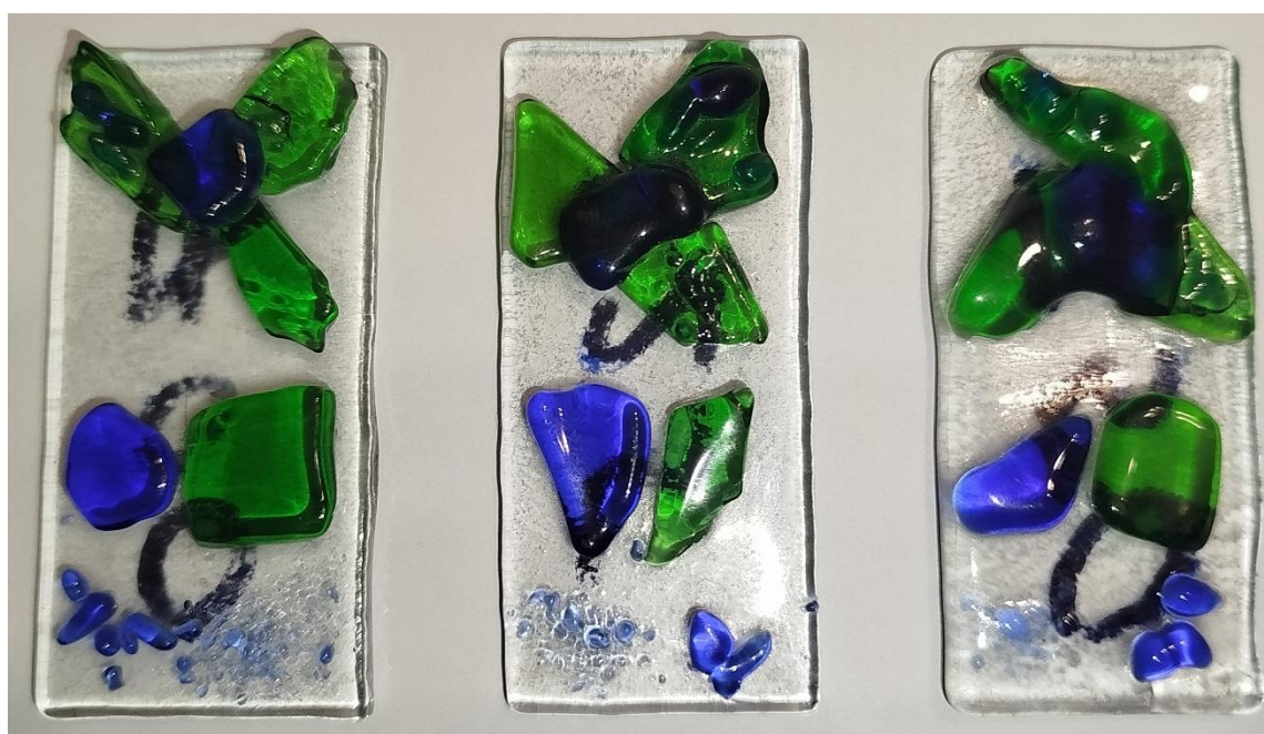
Рис. 3.4. Образцы при разной температуре спекания, а – 700 °С; б – 725 °С; в – 750 °С
