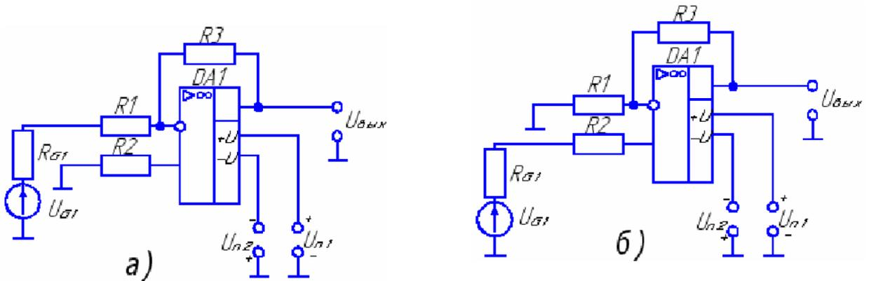
а) Инвертирующий усилитель постоянного тока, б) Не инвертирующий усилитель постоянного тока
