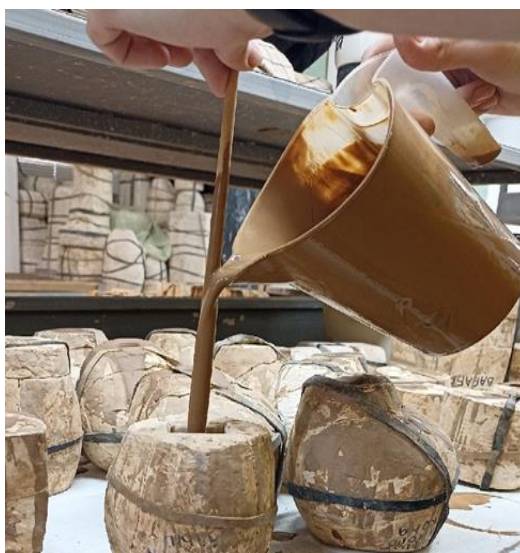
Рис. 11. Процесс заливки шликера в гипсовую форму
