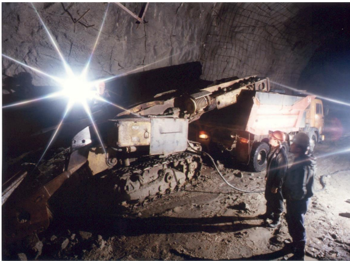
Рис. 4.9. Породопогрузочная машина ПНБ-3Д на гусеничном ходу.
