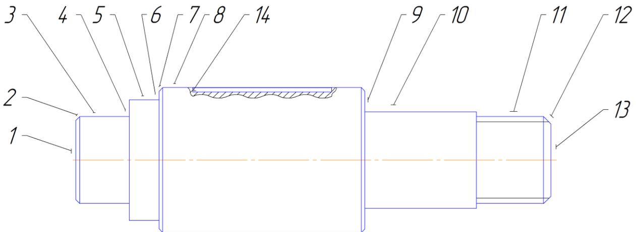
Рисунок 1 – Эскиз детали с номерами обрабатываемых поверхностей
