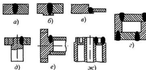
а - стыковое (может быть с бортиком для получения выпуклости шва); б - замковое; в - стыковое деталей разной толщины; г - угловые; д и е - стыковые при сварке шестерён; ж - стыковые с отбортовкой кромок
