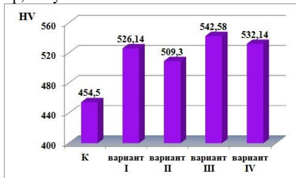
Рисунок 1 - Влияние материала катода имплантера на нанотвердость
