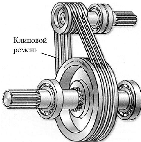
Рис. 11.1. Клиноременная передача
