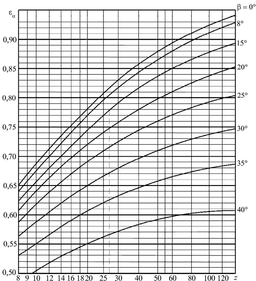
Рис. 8.5. График для определения  $\varepsilon_{\alpha 1}$  и  $\varepsilon_{\alpha 2}$ **10. Скорость и силы в зацеплении:**
