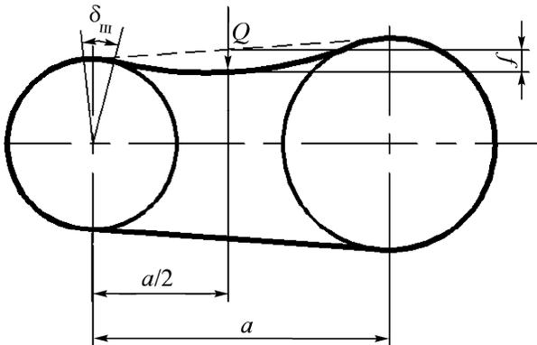
Рис. 11.13. Схема контроля силы предварительного натяжения ремня
