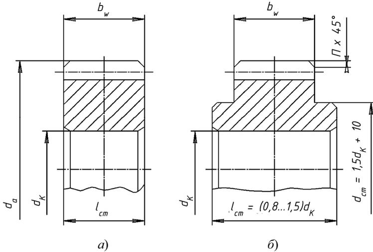
**Рис. 12.3.** Цилиндрические зубчатые кованные колеса при  $d_a < 150$  мм:
