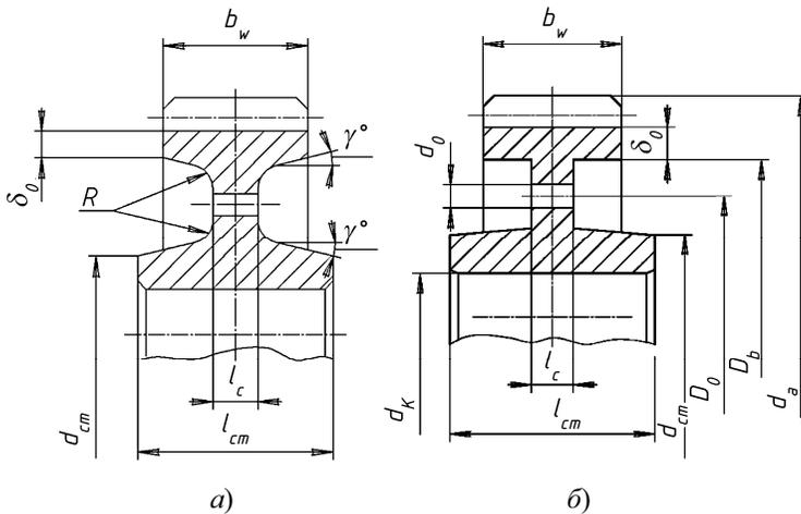
**Рис. 12.4.** Цилиндрические зубчатые колеса при  $150 \text{ мм} \leq d_a \leq 500$  мм:
