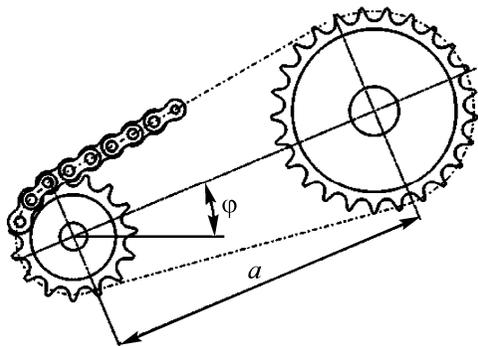
Рис. 10.1. Цепная передача
