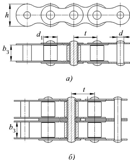
**Рис. 10.2. Цепь роликовая:**
