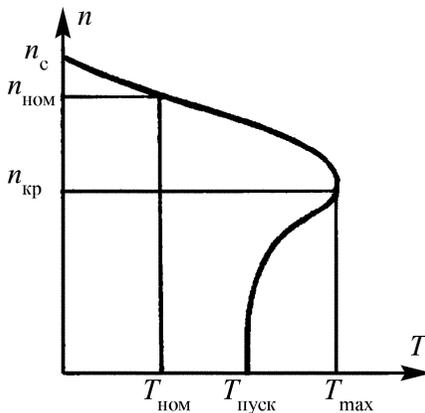
**Рис. 7.1.** Тяговая характеристика асинхронного электродвигателя с короткозамкнутым ротором
