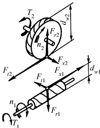
**Рис. 9.1.** Схема распределения сил в червячном зацеплении
