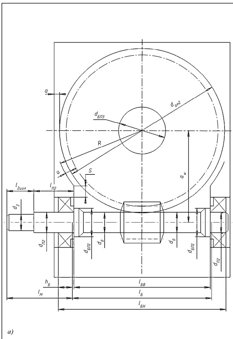
**Рис. 12.9. Пример эскизной компоновки червячного одноступенчатого редуктора:**
