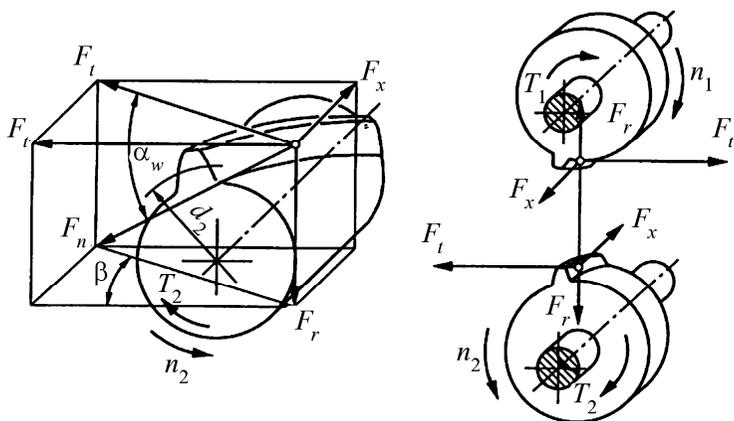
Рис. 8.6. Распределение сил в зубчатом зацеплении
