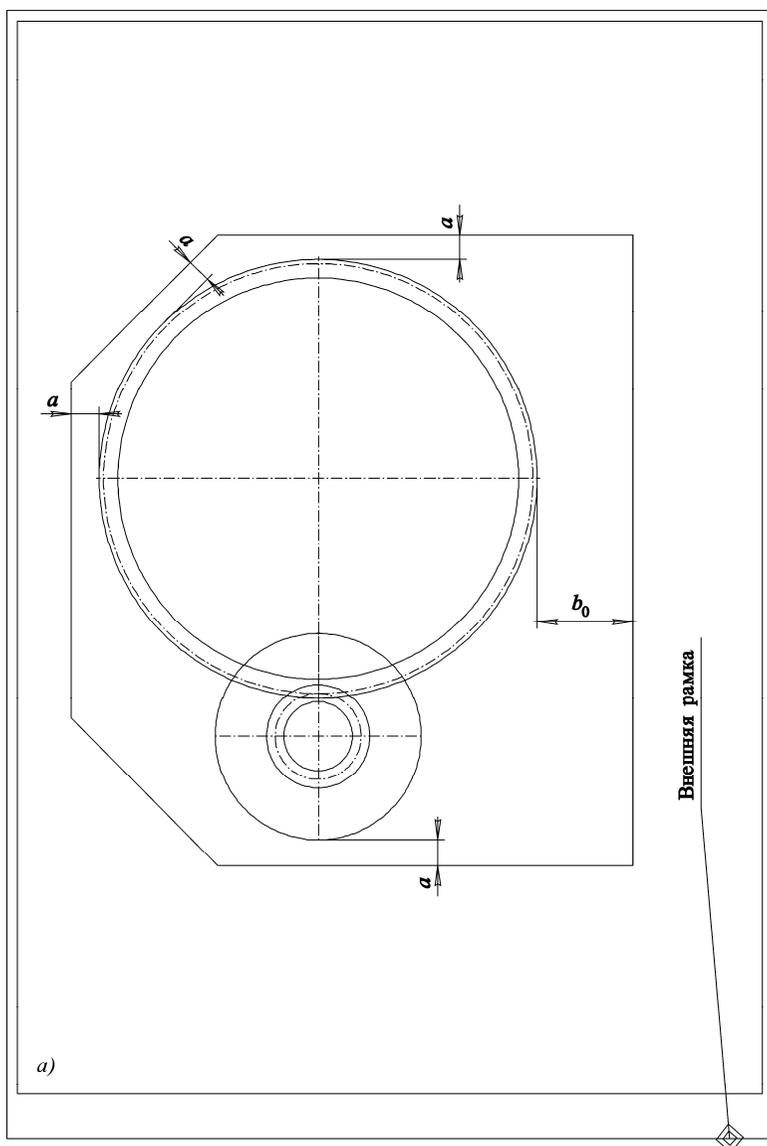
**Рис. 12.8. Пример эскизной компоновки зубчатого цилиндрического одноступенчатого редуктора:**
