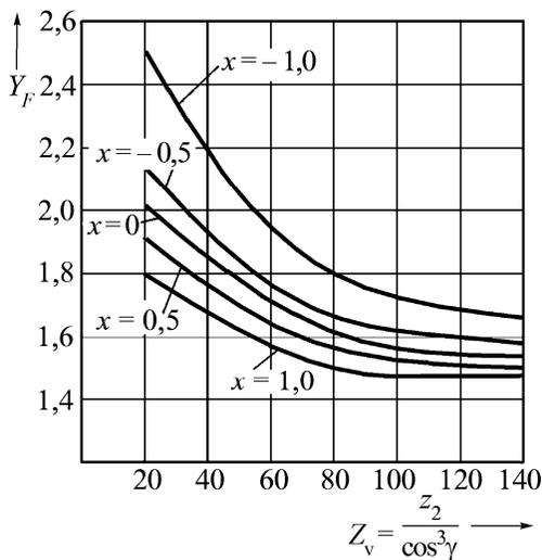
Рис. 9.2. Графики зависимостей  $Y_F = f(Z_v, x)$
