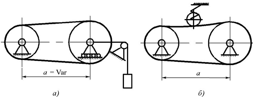
Рис. 11.4. Передачи с автоматическим натяжением ремня (I группа):
