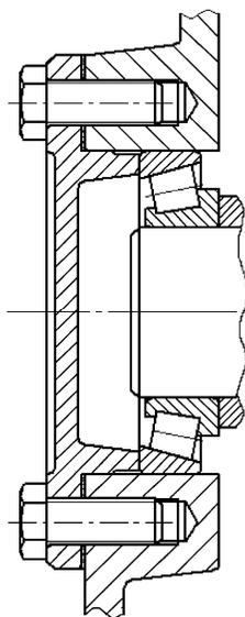
**Рис. 15.2.** Крепление крышки подшипника к корпусу редуктора
