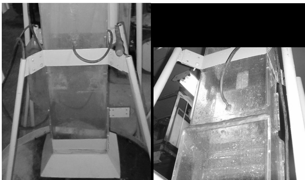
Рис. 4.10.4. Установка измерительной диафрагмы в экспериментальной установке
