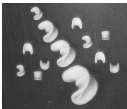
Рис. 4.4.8. Седловидные насадки: а – седла Инталокс, б – седла Берля
