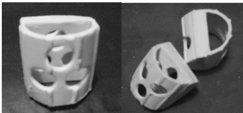
Рис. 4.9.1. Общий вид новой керамической насадки типа N3C
