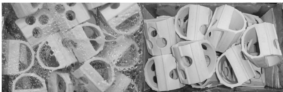
Рис. 4.9.4. Каплеуловитель выполненный из слоя нерегулярно уложенной керамической насадки типа N3C
