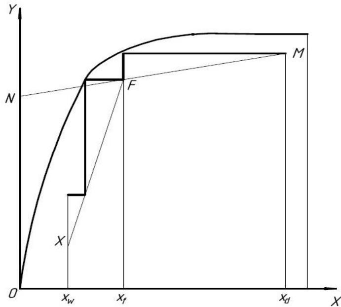
Рис. 3. Диаграмма равновесия для бинарной смеси «аммиак-вода»
