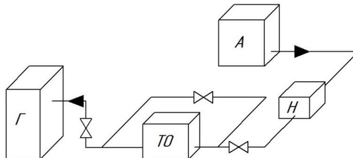
Рис. 4. Схема трубопровода подачи крепкого раствора в генератор
