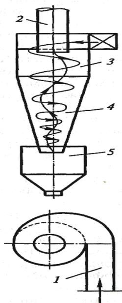
Рис. 2.1. Схема работы циклона.
