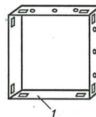
Рис. 2. Ячейковый масляный фильтр ФЯР системы «Рекка»:
