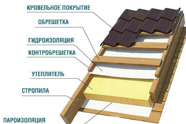
Рис. 4.7 - Вид конструкции кровельного покрытия
