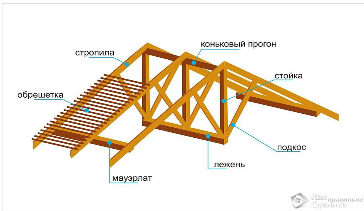
Рисунок 4.4 - Элементы стропильной системы
