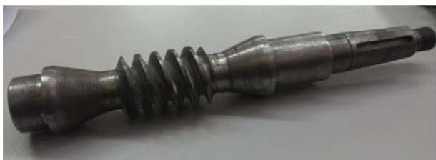
*Рис. П2. Вал-червяк малого диаметра*
