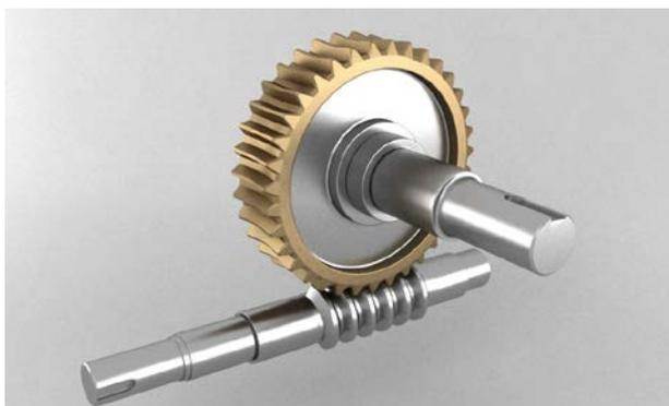
*Рис. П1. 3D-модель червячного зацепления*
