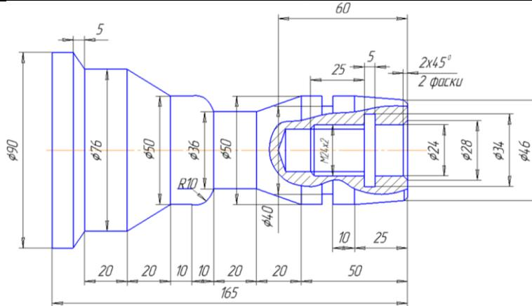
11. Постоянные циклы станка с ЧПУ. Цикл прерывистого сверления и высокоскоростного прерывистого сверления. Разработать программу обработки части детали (слева до цилиндрической части  $\varnothing 70$  мм) на токарном обрабатывающем центре в виде:
