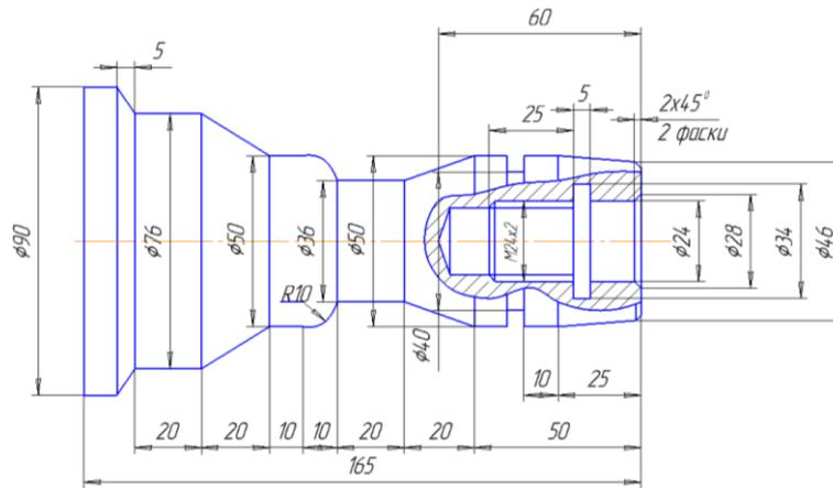
24. Постоянные циклы станка с ЧПУ. Цикл нарезания резьбы и цикл растачивания. Разработать программу обработки части детали (до дуги  $R=10\text{мм}$ ) на токарном обрабатывающем центре в виде:
