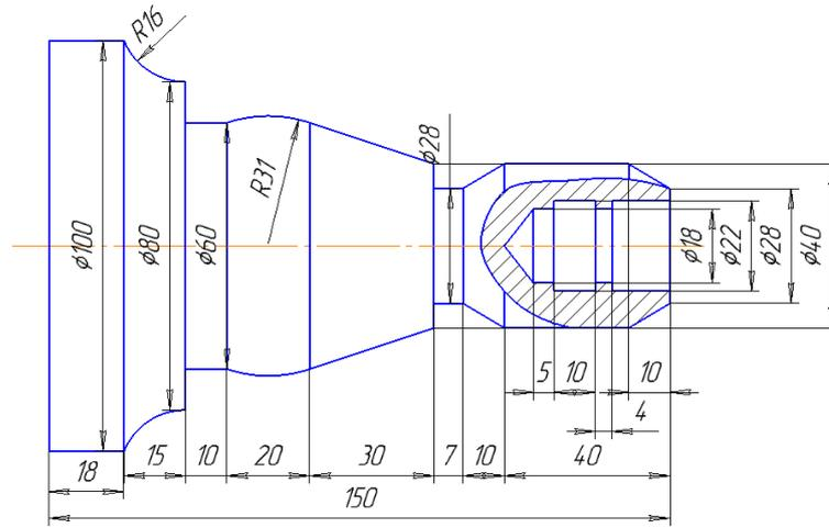
23. Постоянные циклы станка с ЧПУ. Цикл прерывистого сверления и высокоскоростного прерывистого сверления. Разработать программу обработки части детали (до цилиндрической части  $\phi 36$  мм) на токарном обрабатывающем центре в виде:
