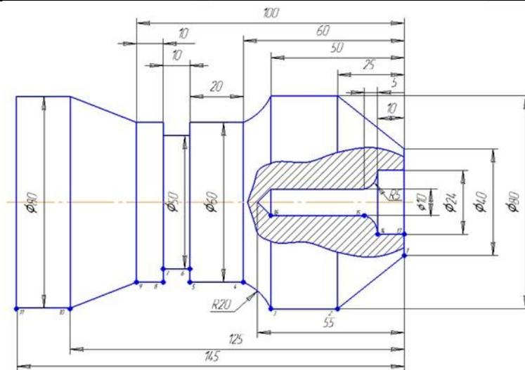
18. Базовые G коды. Ускоренное перемещение, линейная интерполяция, круговая интерполяция. Разработать программу обработки части детали (до шейки Ø26 мм) на токарном обрабатывающем центре в виде:
