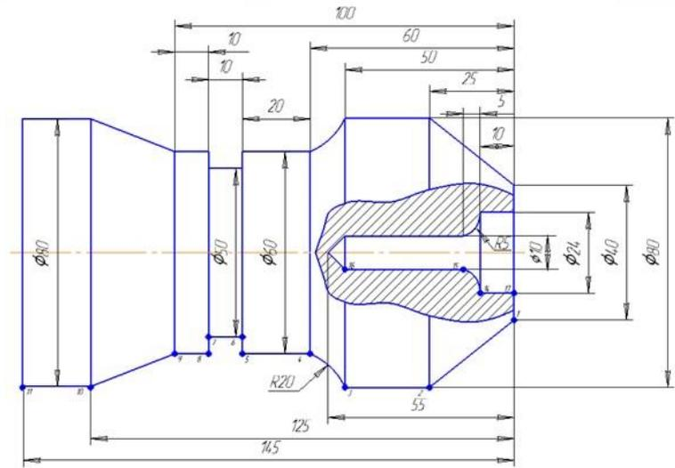
14. Методы программирования. Схема работы с CAD/CAM/CAE системой. Разработать программу обработки части детали (до радиусной части включительно без нарезания резьбы) на токарном обрабатывающем центре в виде:
