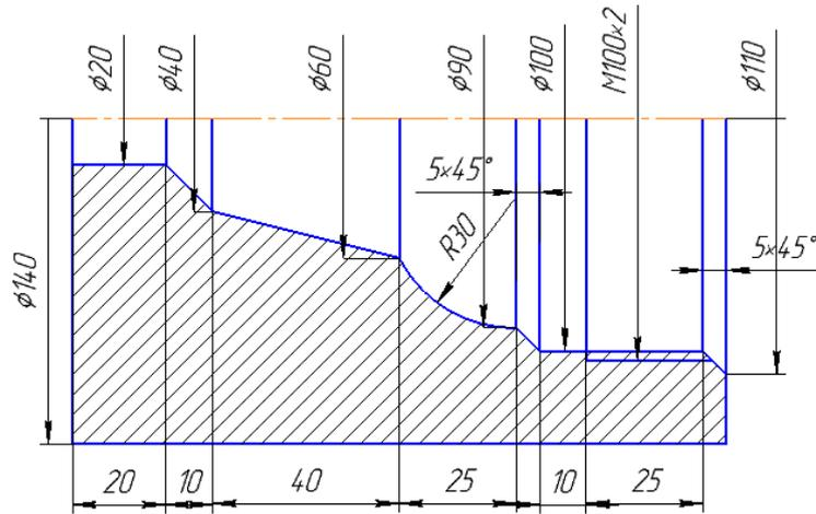
15. Станочная система координат. Нулевая точка станка и направления перемещений. Разработать программу обработки части детали (до начала радиусной части R=18 мм) на токарном обрабатывающем центре в виде:
