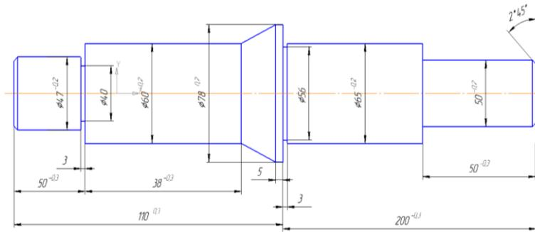
2. Функциональные составляющие ЧПУ. Подсистема обратной связи. Датчики положения, состояния исполнительных органов. Разработать программу обработки части детали (до цилиндрической части  $\varnothing 70$  мм) на токарном обрабатывающем центре в виде:
