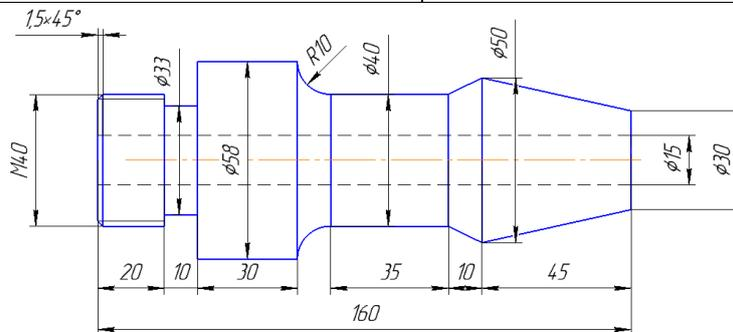
25. Основы эффективного программирования. Внутренняя и внешняя подпрограммы. Разработать программу обработки части детали (до дуги  $R=20\text{ мм}$ ) на токарном обрабатывающем центре в виде:
