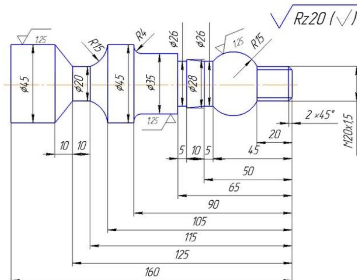
19. Базовые G коды. Программирование дуг при помощи R или I, J, K слов данных. Разработать программу обработки части детали (до дуги R=10 мм включительно) на токарном обрабатывающем центре в виде:
