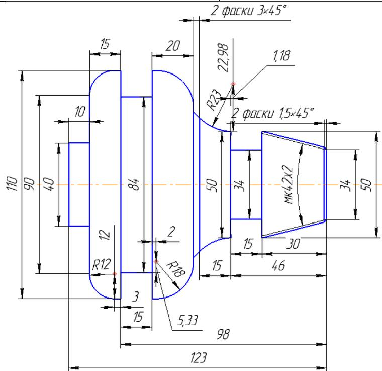
16. Станочная система координат. Нулевая точка программы и рабочая система координат. Разработать программу обработки части детали (до начала дуги R=30 мм) на токарном обрабатывающем центре в виде:
