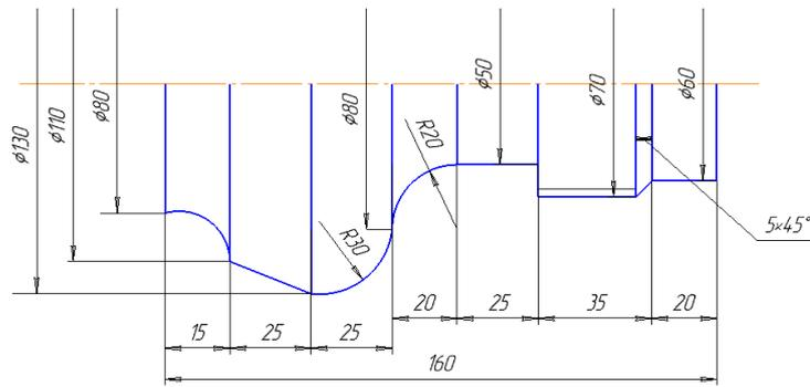
17. Компенсация длины инструмента. Абсолютные и относительные координаты. Разработать программу обработки части детали (до шейки Ø50 мм) на токарном обрабатывающем центре в виде:
