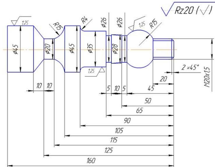
13. Основы эффективного программирования. Внутренняя и внешняя подпрограммы. Разработать программу обработки части детали (до шейки Ø50 мм) на токарном обрабатывающем центре в виде:
