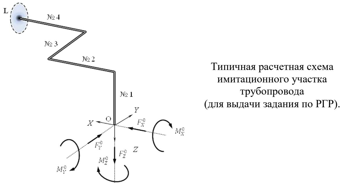
Основой для выполняемых оценок являются показания системы тензодатчиков, располагаемых в заданных позициях на поверхности отдельных звеньев. Конкретная пространственная ориентация звеньев, характерные размеры, а также таблицы показаний датчиков, выдаваемые индивидуально каждому обучающемуся в качестве варианта задания, в каждом случае генерируются специальной компьютерной программой случайным образом. Форма выдачи типичного задания представлена ниже:
