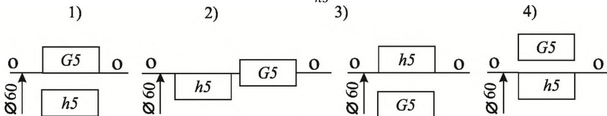
Определите максимальный зазор и диапазон посадки.
