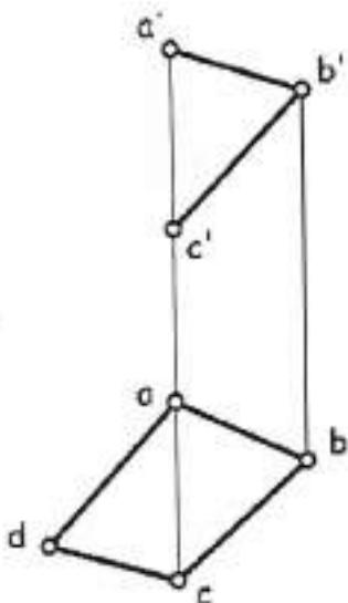
**3.** Построить проекции прямоугольника АВСД со стороной ВС = 50 мм, расположенной на прямой МН, параллельной плоскости Н.
