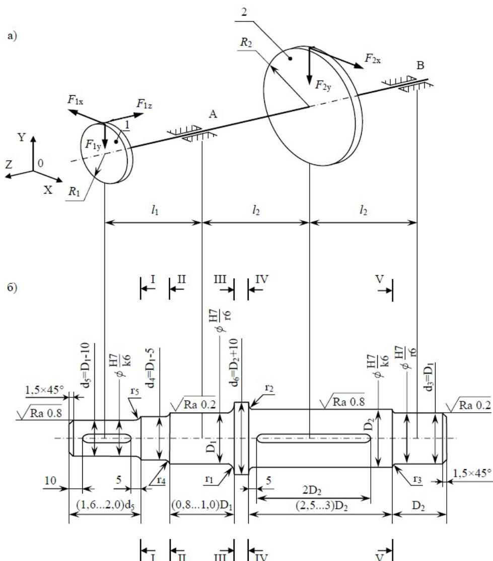
Вал редуктора вращается в двух подшипниковых опорах А и В и несет косозубую (1) и прямозубую (2) зубчатые шестерни с начальными радиусами  $R_1$  и  $R_2$ , нагруженными в точках зацепления усилиями, как показано на рисунке. Необходимо:
