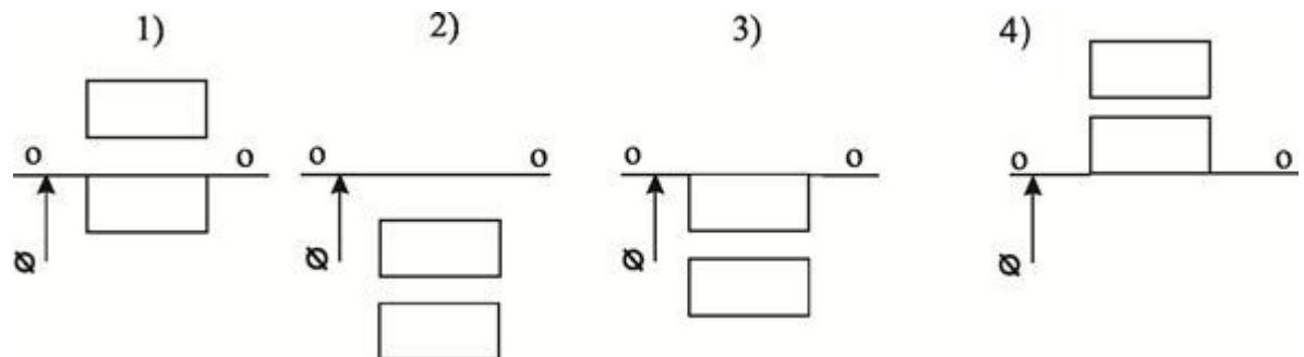
10. Определите правильный вариант простановки размера в буквенном выражении на сборочном чертеже.
