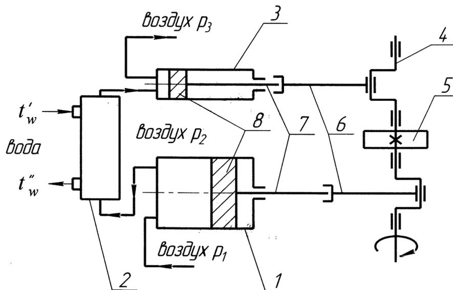
Схема двухступенчатого двухцилиндрового ПК простого действия:
