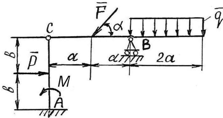
Определить реакции связей в точках  $A$ ,  $B$  и  $C$  шарнирно-сочлененной Г-образной балки  $AB$ , если известны:  $P$  (Н),  $q$  (Н/м),  $M$  (Нм),  $\alpha^\circ$ ,  $a$  (м),  $b$  (м),  $P$  (Н).
