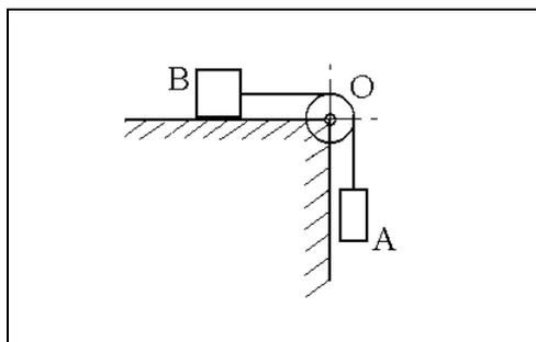
Для системы грузов А и В с весами  $P_1$  и  $P_2$  и блока весом  $Q$  с массой, равномерно распределенной по ободу, определить:
