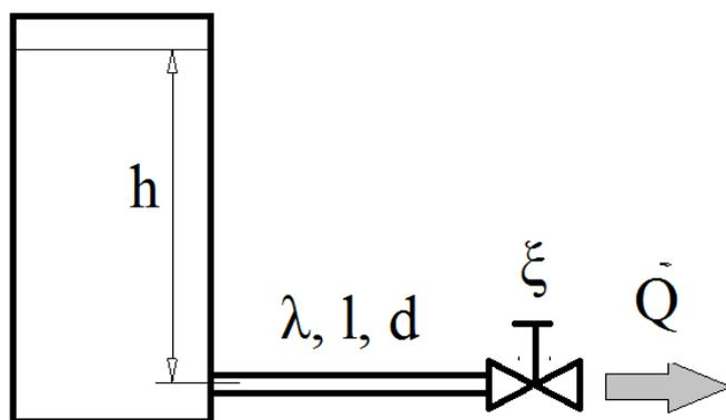
Трубопровод с краном на конце подключен к баку. Производительность трубопровода  $Q$ . Определить высоту уровня жидкости в баке.
