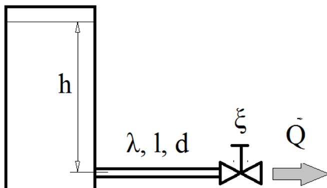
Трубопровод с краном на конце подключен к баку. Высота уровня жидкости в баке  $h$ . Определить производительность трубопровода
