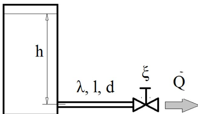
Трубопровод с краном на конце подключен к баку. Высота уровня жидкости в баке  $h$ . Определить длину трубопровода  $l$  при которой прекратится истечение жидкости. Высоту  $h$  считать постоянной.
