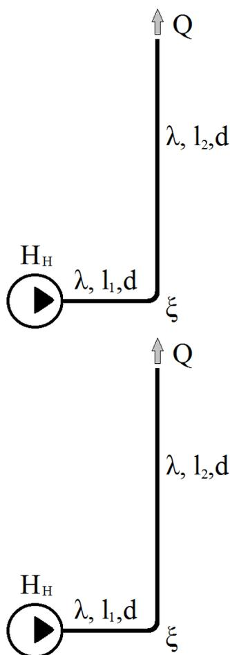
Определить, какой напор должен быть у насоса для подъема воды на высоту  $l_2$
